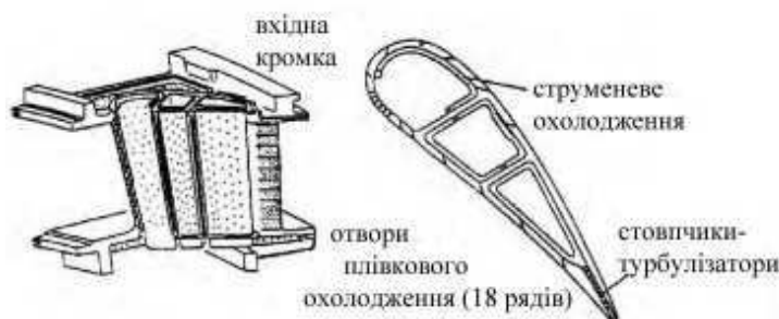
Рис. 1.2. Схема охолодження СЛ першого ступеня двигуна М701G1
