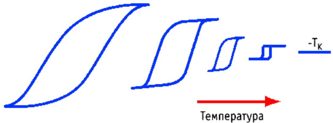
Рис. 3 Изменение петли гистерезиса при приближении к точке Кюри
